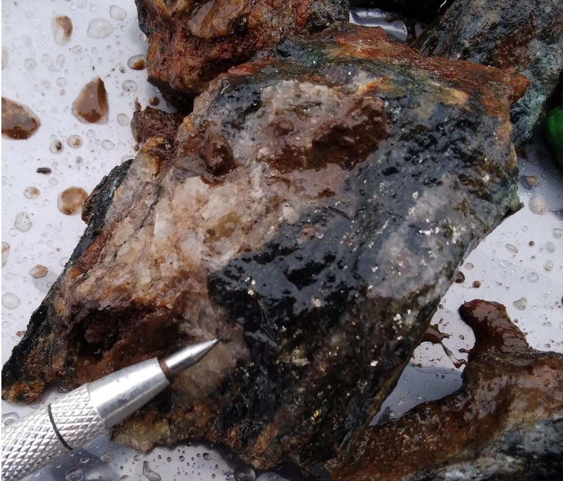
Photo 4 - Secteur de la nouvelle découverte de Georgekish en 2021 d'une veine de quartz aurifère titrant **61,8 g/t Au** et **35,8 g/t Ag**, bloc de claims du centre-nord du Projet. L'échantillon est une veine de quartz déformée oxydée (par oxydation de sulfures) encaissée dans des conglomérats altérés contenant de la chlorite avec de la pyrite disséminée..
