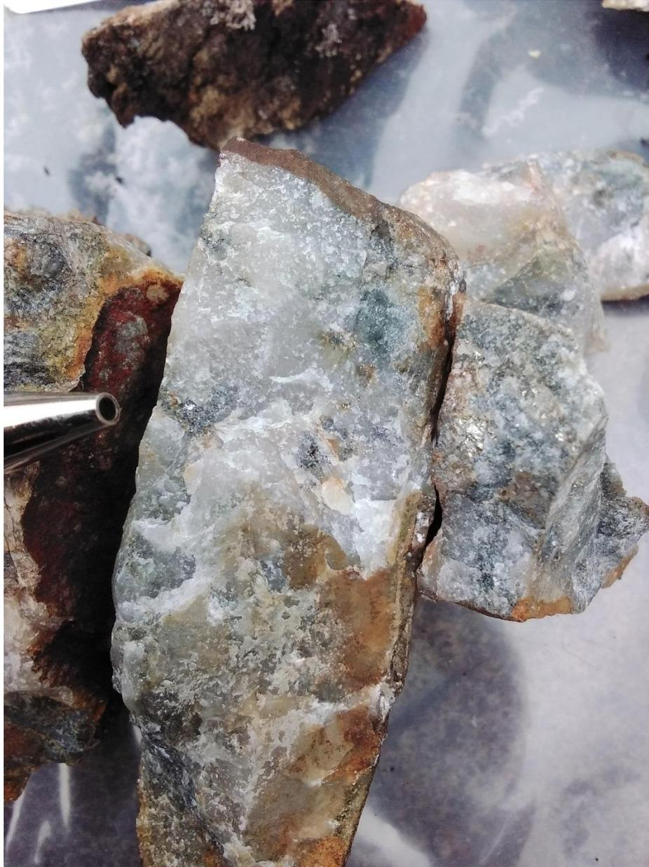
Photo 2 - Secteur de la découverte Lloyd en 2021 - Échantillon de veine de quartz aurifère avec galène (plomb), sphalérite (zinc), chalcopryrite (cuivre) et pyrite.
